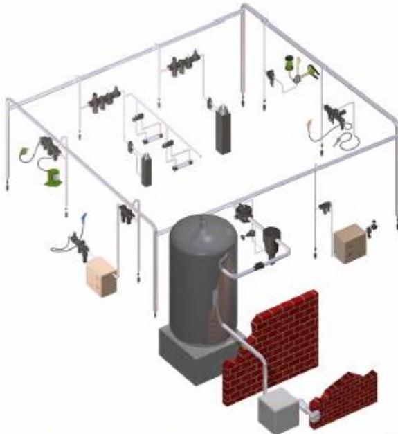
Exemple de réseau de distribution d'énergie pneumatique [5]
