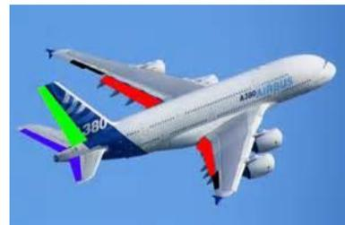
L'airbus A380 est équipé de quatre gouvernes de profondeur disposées symétriquement sur le plan horizontal réglable (PHR) de l'avion. Chaque gouverne de profondeur est reliée au PHR par des charnières et est mis en rotation par une unité de commande constituée de deux actionneurs :
