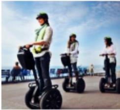
La conduite du Segway® se fait par inclinaison du corps vers l'avant ou vers l'arrière, afin d'accélérer ou freiner le mouvement. Les virages à droite et à gauche sont commandés par la rotation de la poignée directionnelle.
