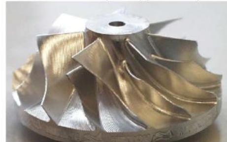
Exemple de pièce complexe obtenue par usinage
