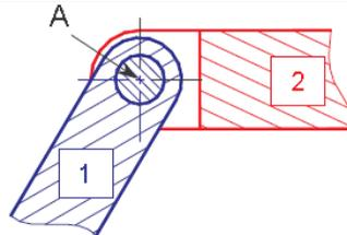
$$\vec{V}_{(A \in 1/0)} = \underbrace{\vec{V}_{(A \in 1/2)}}_0 + \vec{V}_{(A \in 2/0)}$$
