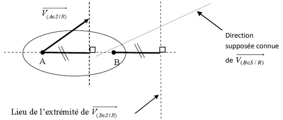
Dans le mouvement d'un solide indéformable 1 par rapport à un solide de référence 0, les vecteurs vitesses de deux points quelconques A et B,  $\vec{V}_{(A \in 1 / 0)}$  et  $\vec{V}_{(B \in 1 / 0)}$ , ont même projection sur la droite (AB).
