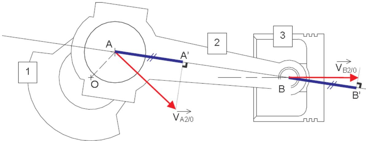
$\vec{V}_{(A \in 2/0)} = \vec{V}_{(A \in 1/0)}$  car A est centre de la rotation 2/1. Ce vecteur est donc perpendiculaire au rayon OA.
