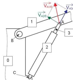
$$\vec{V}_{A1/0} = \vec{V}_{A3/0} = \vec{V}_{A3/2} + \vec{V}_{A2/0}$$
