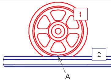
$$\vec{V}_{(A \in 1/0)} = \underbrace{\vec{V}_{(A \in 1/2)}}_0 + \vec{V}_{(A \in 2/0)}$$
