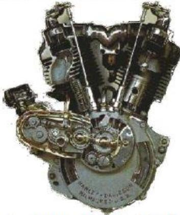
Pour les moteurs V-Twin (à l'origine de la réputation des Harley) la soupape est commandée par la rotation d'une came synchronisée à la rotation du vilebrequin (par des engrenages). Une tige et un culbuteur permettent de transmettre le mouvement à la soupape. Un ressort de rappel assure le retour de la soupape.
