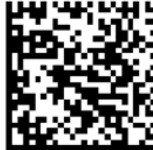
Le code **DataMatrix** est un code bidimensionnel à haute densité, permettant de représenter une quantité importante d'informations sur une surface réduite.
