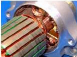
Moteur à courant continu ( commutation mécanique)
