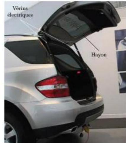
La commande d'ouverture et de fermeture du coffre est assurée par un asservissement de position angulaire  $\theta$  du hayon. L'étude porte sur l'asservissement d'un seul vérin que nous appellerons *vérin maître*.
