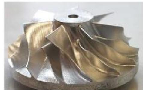
Exemple de pièce complexe obtenue par usinage
