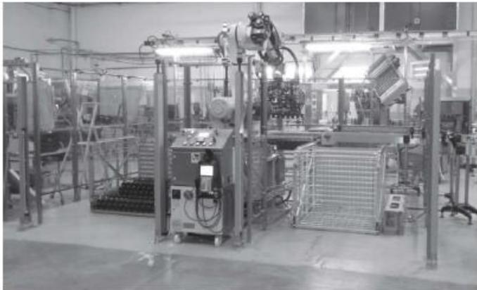
Figure 1 – Cellule robotisée d'emboilage et de transfert
