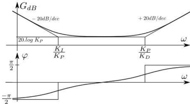
Nous ne détaillerons pas l'influence de ce correcteur sur un système asservi car ses propriétés se rapprochent fortement de celles des correcteurs proportionnel-intégral et proportionnel-dérivé. C'est le correcteur qui est certainement le plus utilisé dans les systèmes asservis, mais qui est aussi le plus délicat à régler. Il permet, si les paramètres sont bien choisis, d'avoir les avantages des trois types de correcteur
