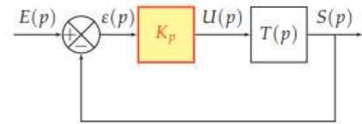
FIGURE 9 – Asservissement du moteur avec correcteur proportionnel.
