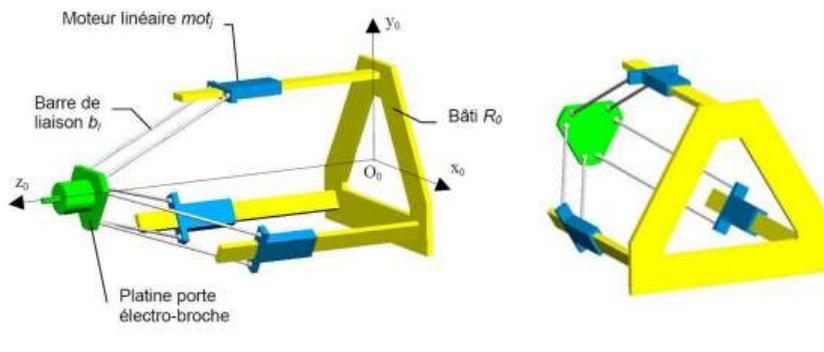
FIGURE 3 – Shéma de principe de la structure parallèle (structure delta) commandée par trois moteurs linéaires.
