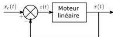
FIGURE 8 – Schéma bloc du moteur linéaire asservi en position, non corrigé.
