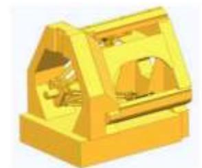
FIGURE 2 – Vue 3D du bâti intérieur et de la structure parallèle portant la broche.
