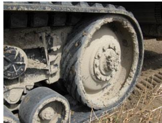
Entrainement d'une chenille par roue de friction
