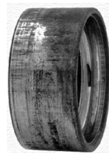
Laminage d'une bague extérieure
