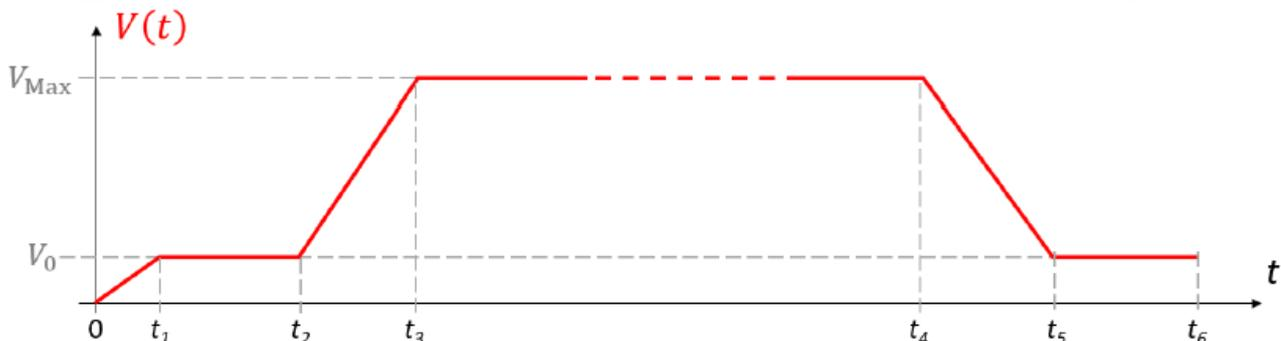
Le CDC impose le temps total  $t_6$  ainsi que les différentes accélérations ainsi que la course totale  $c$  parcourue entre  $t = 0$  et  $t_6$ . Il reste à déterminer les temps  $t_1$  à  $t_5$  pour piloter les moteurs de la poulie motrice.
