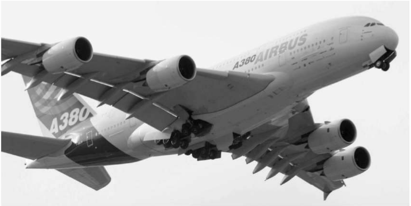
Figure 3 : sortie des trains d'atterrissage sur l'A380
